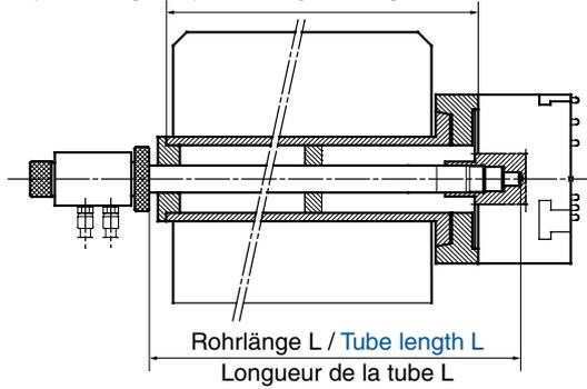
Zur Herstellung der Luftzufuhr-Rohre benötigen wir die genaue Angabe entweder der Spindellänge oder aber der Länge L des Luftzufuhr-Rohres.
