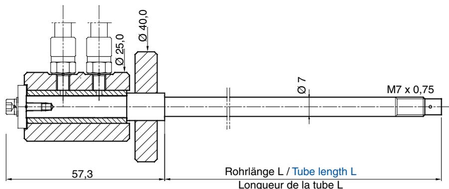
**Einsatz:** ROTOR Präzisions-Spannfutter Type 50/3 und 50/2 sowie – mit entsprechendem Adapter – für neue PML- sowie graber-Futter, sofern der Spindel-Durchlass den Einsatz von N- oder B-Rohren mit  $\varnothing$  10 resp. 16 mm nicht erlaubt.
